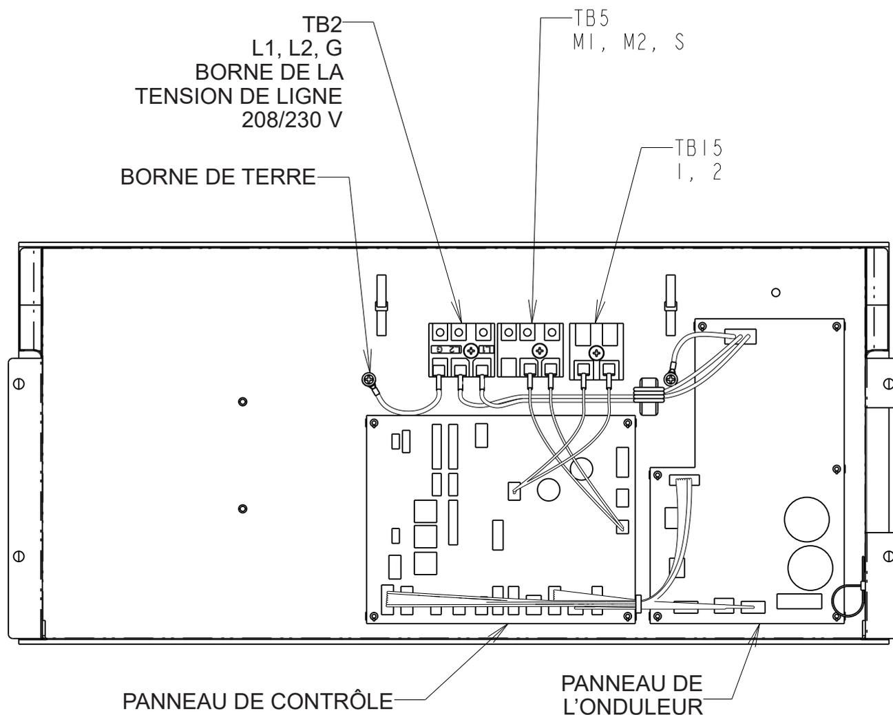
**Raccordement des câbles de la commande à distance et des câbles de transmission intérieurs et extérieurs**
