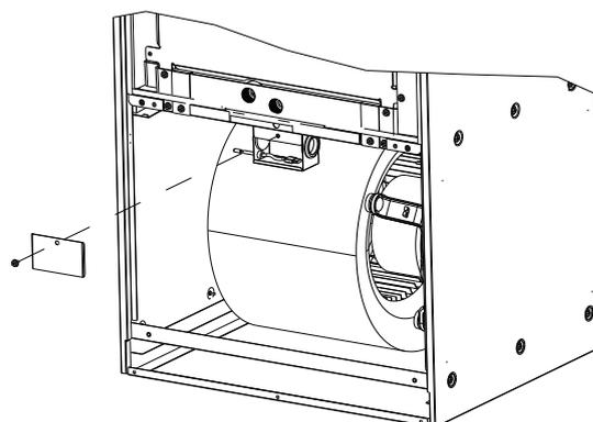
**Étape 5** Retirez le couvercle du boîtier électrique monté sur le bloc ventilateur. Débranchez le connecteur du moteur ainsi que le connecteur de la thermistance de retour d'air. Retirez tous les faisceaux du boîtier électrique pour ne laisser que la thermistance de retour d'air attachée au boîtier électrique.
