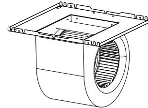
**Étape 9** Faites tourner le bloc ventilateur de 180°. Le moteur doit désormais se trouver sur le côté opposé.
