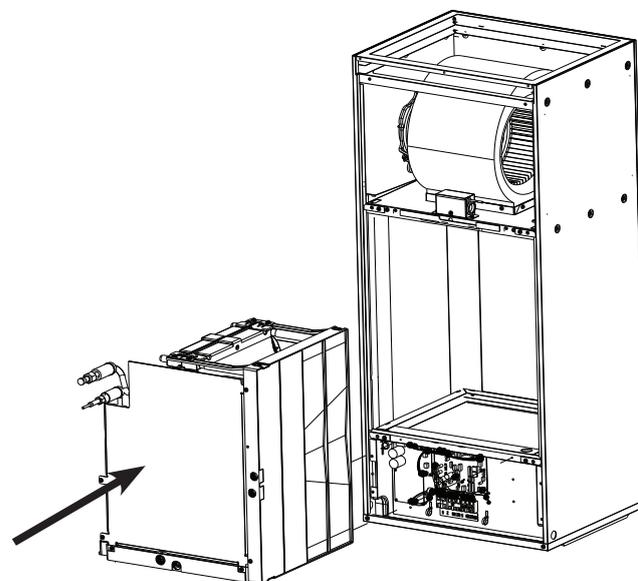
**Étape 4a** Remettez la bobine dans le caisson. Il n'est pas nécessaire de rattacher le(s) support(s).
