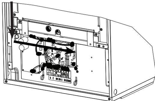
**Étape 4b** Coupez les serre-câbles en plastique qui retiennent le surplus de câbles du LEV (CN60) et de la thermistance (CN44). Faites passer les fils du LEV et de la thermistance dans la partie électrique de la centrale de traitement d'air du côté gauche de la bobine.
