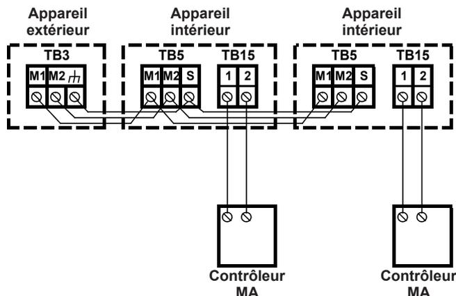
La commande à distance MA et la commande à distance M-NET ne peuvent pas être utilisées simultanément et elles ne sont pas interchangeables.
