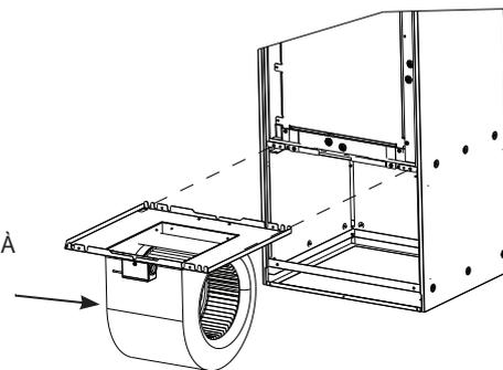
**Étape 11** Remettez le bloc ventilateur avec le moteur désormais à gauche dans le caisson de la centrale de traitement d'air et réutilisez les vis (2) pour fixer le bloc ventilateur en position. Acheminez à nouveau les connecteurs (2) du moteur dans le boîtier et rebranchez-les.
