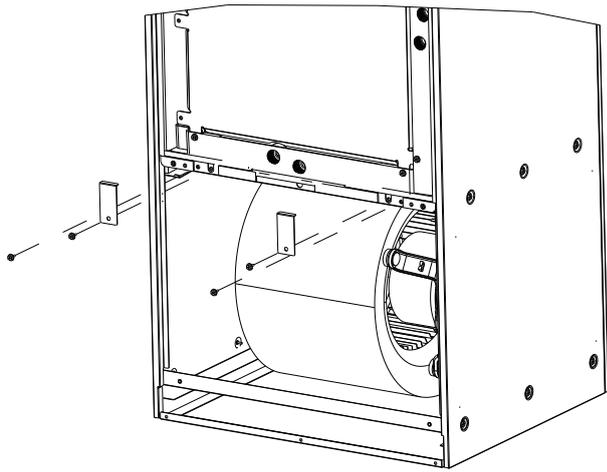
**Étape 6** Retirez les vis (4) indiquées sur l'image ainsi que les supports de fixation de la bobine.
