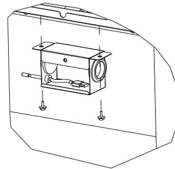
**Étape 10** Réinstallez le boîtier du capteur de température de l'air de retour sur le bloc ventilateur sur le côté opposé de son emplacement d'origine.
