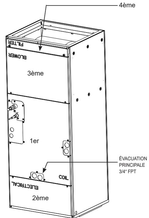
**Étape 5** Réinstallez les panneaux sur les tuyaux d'écoulement et lignes de réfrigérant. Ensuite, installez les panneaux de la bobine (1<sup>er</sup>), de la partie électrique (2<sup>ème</sup>), du ventilateur (3<sup>ème</sup>) et du filtre (4<sup>ème</sup>). **REMARQUE :** Le panneau de la bobine doit être installé dans le bon sens, c'est-à-dire dans l'orientation verticale d'origine à la sortie d'usine, tandis que le texte des autres panneaux sera à l'envers.
