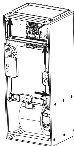
**Étape 4b** Ensuite, retirez les petits panneaux couvrant les trous d'évacuation et lignes de réfrigérant en les faisant glisser d'abord dans la direction indiquée ci-dessus.
