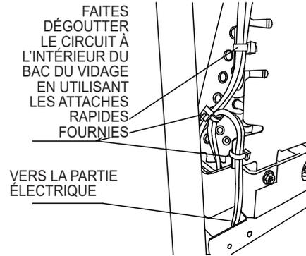
**Étape 4c** Afin d'empêcher l'eau de couler sur les fils de la thermistance dans la partie électrique, une boucle d'égouttement DOIT être installée pour diriger l'eau dans le bac de récupération à l'aide des attaches rapides fournies du sac d'accessoires.
