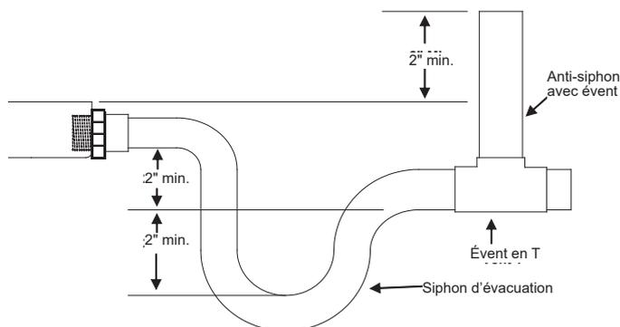
**Remarque:** Les conduits horizontaux doivent également avoir un anti-siphon avec évènement (colonne montante) installé au-dessus du conduit horizontal pour éliminer le piégeage de l'air. Les lignes d'évacuation horizontales doivent avoir une inclinaison de minimum 1/4" par pied.
