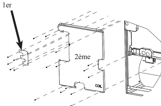
**Étape 4a** Retirez les vis de fixation des panneaux (3) au panneau COIL comme indiqué sur l'image ci-dessus. Retirez le "1er" panneau et le "2ème" panneau portant l'inscription "COIL".
