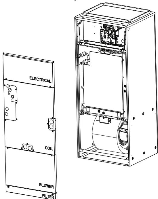
**Étape 1** Reportez-vous à 9.3. Étape 1 à 4 pour le retrait des panneaux de la partie électrique, de la bobine, du ventilateur et du filtre.
