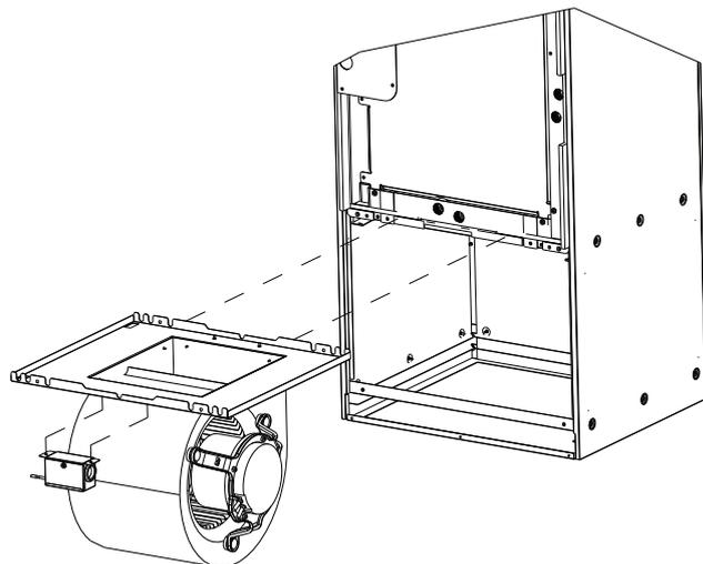
**Étape 8** Retirez le boîtier électrique du bloc ventilateur.
