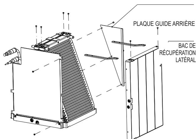
**Étape 13** Retirez la plaque guide arrière (3 vis) et le bac de récupération latéral (4 vis) ainsi que les supports de fixation (4 vis) de la bobine.
