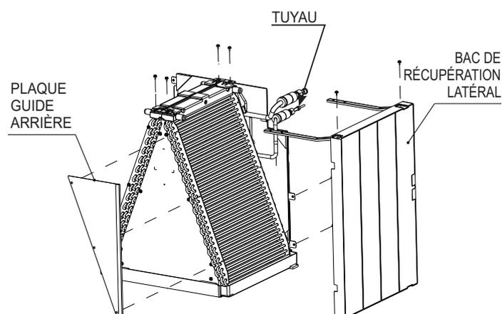
**Étape 14b** Réinstallez les supports sur le côté opposé du bac de récupération latéral. Le bac de récupération latéral est réinstallé sur le côté opposé de la bobine. Remettez la plaque guide arrière en place sur le côté opposé de la bobine.
