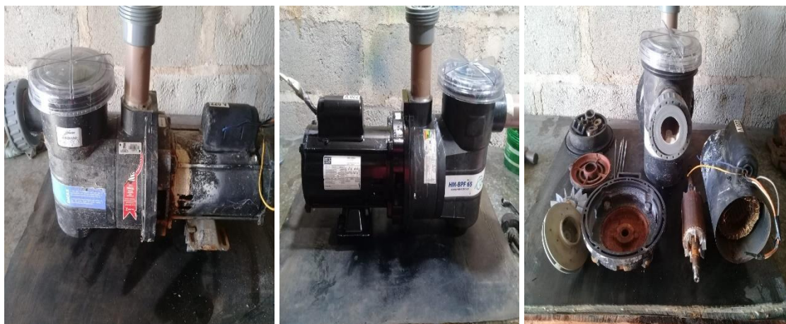
Imagens de serviços da manutenção, conservação e pintura de bombas de água.
