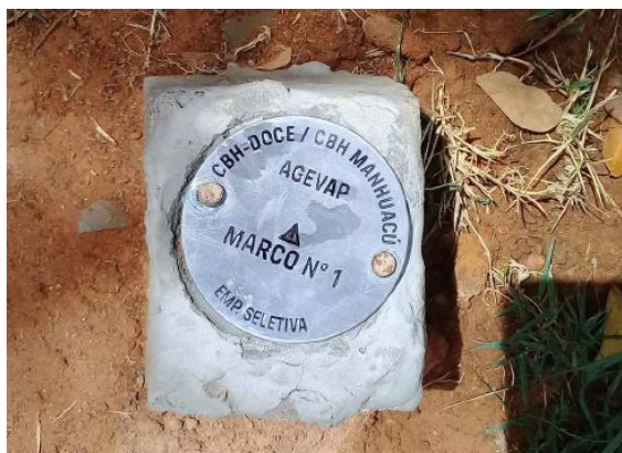
Figura 1 - Exemplo de marco topográfico
