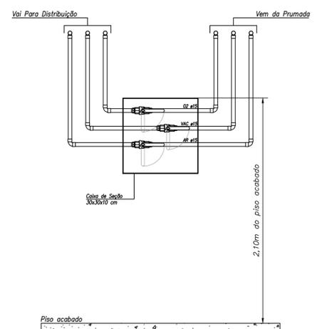
**DETALHE A - CAIXA DE SEÇÃO 1º PAVIMENTO REDE Ø 22mm**
