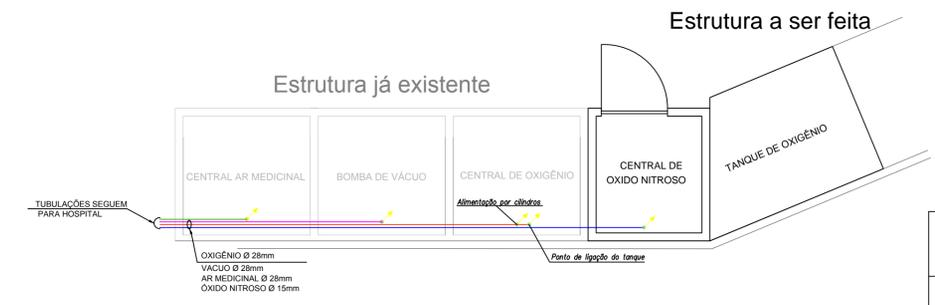
**DETALHE ABRIGO DOS GASES**
