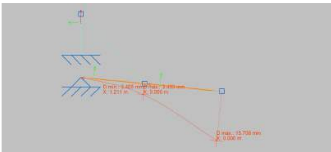
Figura 03 – Deformada máxima terça (15,708 mm)
