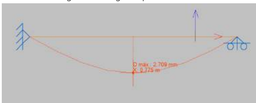
Figura 08 – Deformada máxima no Patamar (2,709mm)
