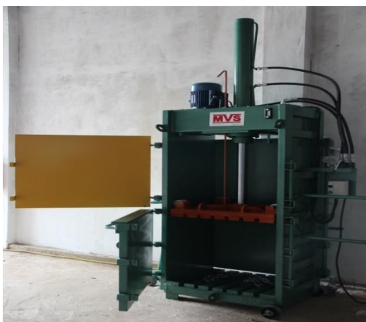
Figura 3-72 - Prensa compactadora de resíduos sólidos doada para a associação.
