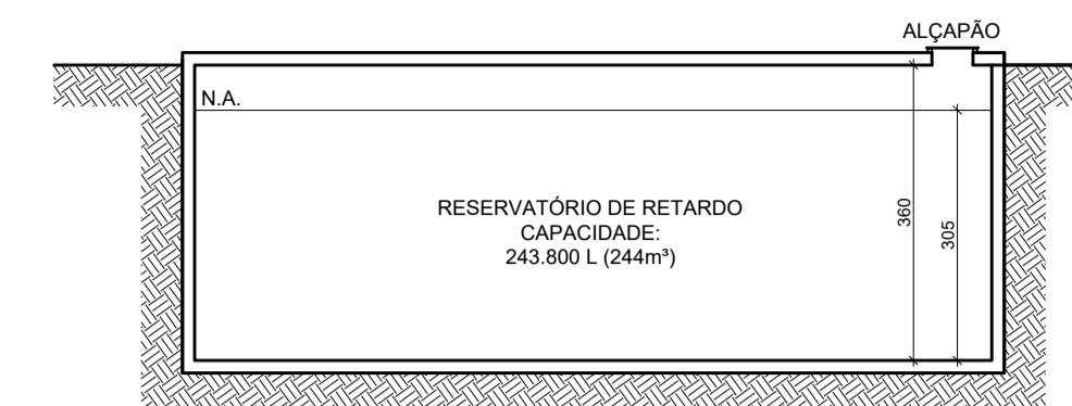
CORTE GG' RESERVATÓRIO ESCALA: 1/100
