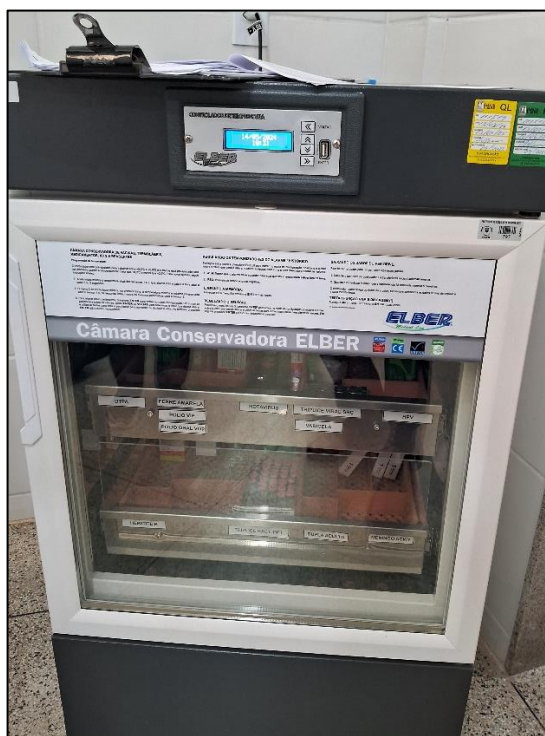
Imagem 28 – Modelo de câmara de refrigeração com sistema automático de envio de mensagens e chamada telefônica disponível, mas inoperante (Sala de Vacinação USF Minete – Venda Nova do Imigrante)
