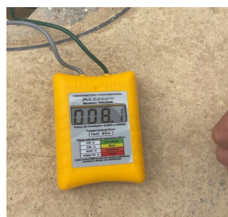
TESTE DE SISTEMA DE PROTEÇÃO CONTRA DESCARGAS ATMOSFERICAS (SPDA).
