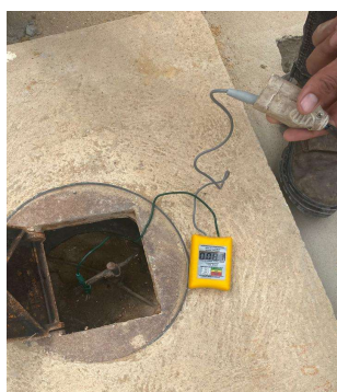
TESTE DE SISTEMA DE PROTEÇÃO CONTRA DESCARGAS ATMOSFERICAS (SPDA).
