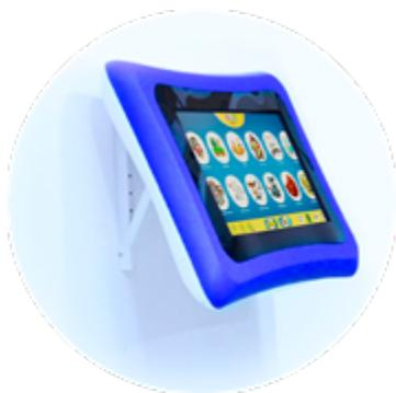
A tela é instalada de forma embutida, não permitindo acesso do usuário comum aos componentes internos, evitando danos ou acidentes. A tela de toque possui uma camada de proteção de 4mm para proteção dos componentes.
