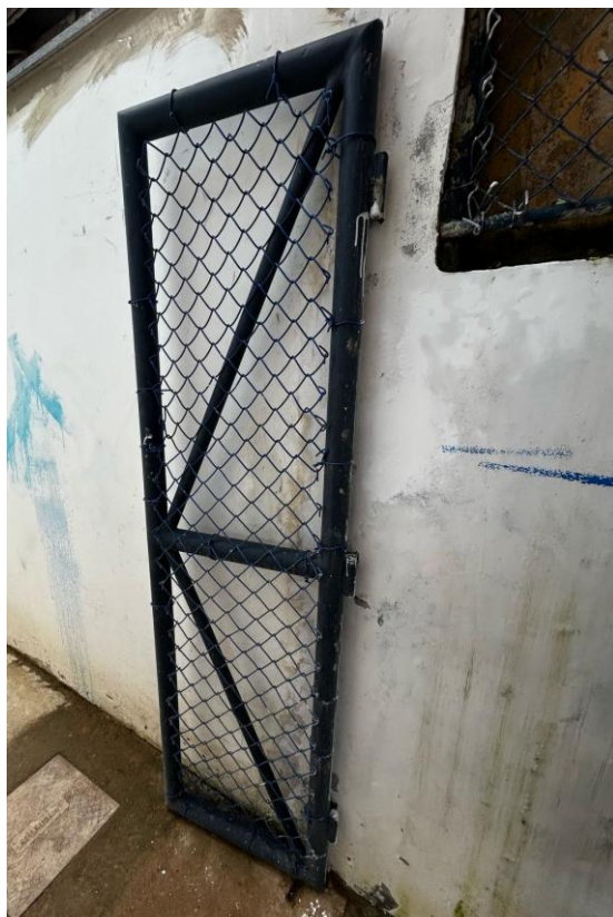
Foto 10 – Item 09.01.14 - PORTÃO EM TELA ARAME GALVANIZADO N.12 MALHA 2" E MOLDURA EM TUBOS DE AÇO COM DUAS FOLHAS DE ABRIR, INCLUSO FERRAGENS
