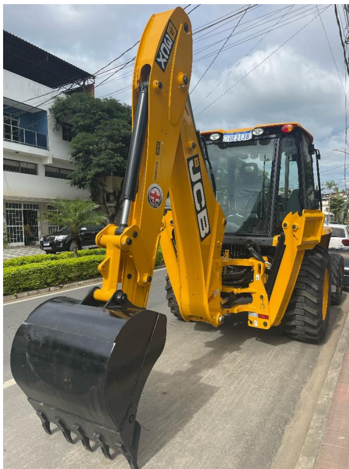
Figura 01: Retroescavadeira JCB 3CX.
