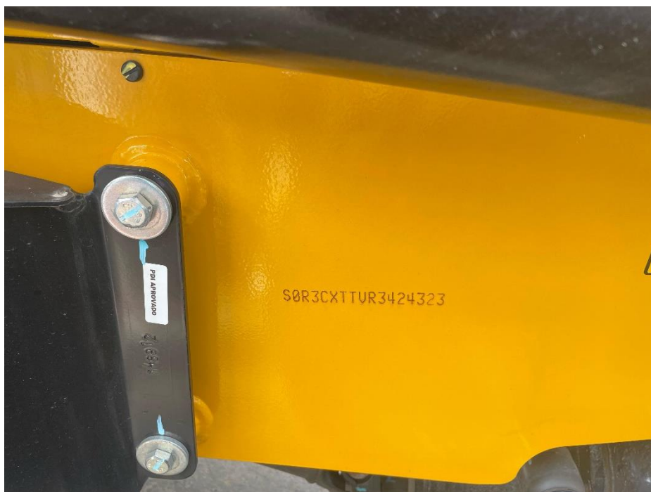
Figura 06: Detalhe para a identificação do número do chassi.
