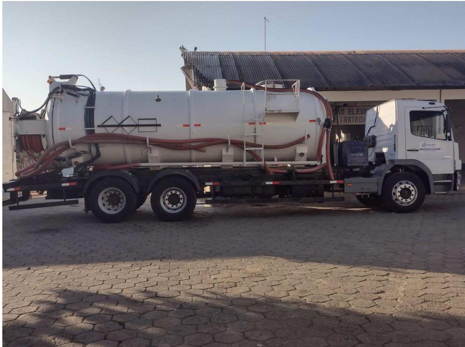
*Figura 71: Hidrojato utilizado na manutenção das redes de esgoto*
