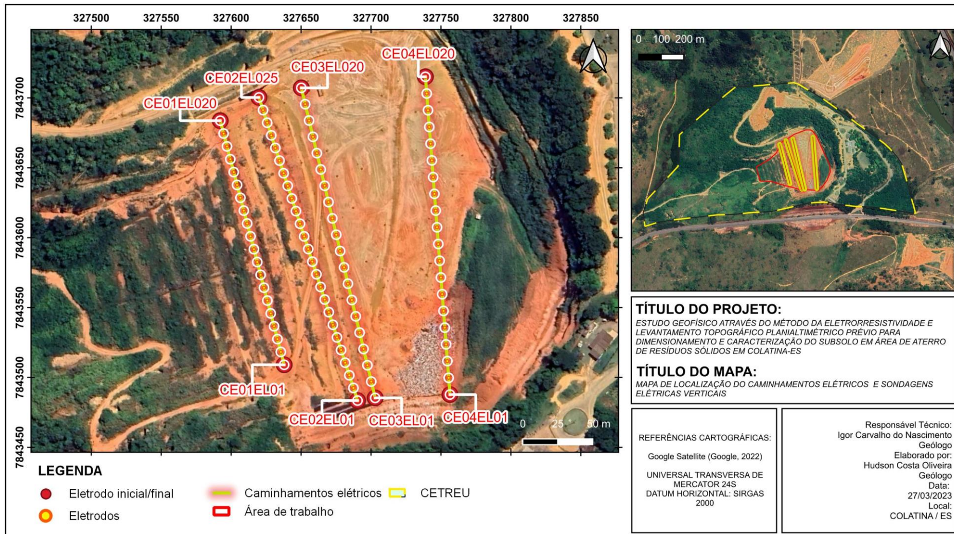
Figura 17: Mapa de localização e situação dos caminhamentos elétricos executados na área do CETREU.
