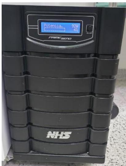
Figura 62. Bateria externa (*nobrek*) acoplada a câmara refrigerada (UBS II - Anchieta)
