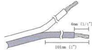
3. Utilizando o alicate descascador de cabos, remova aproximadamente 1/4" (6mm) do revestimento de cada fio. Então, dobre as extremidades de cada cabo.
