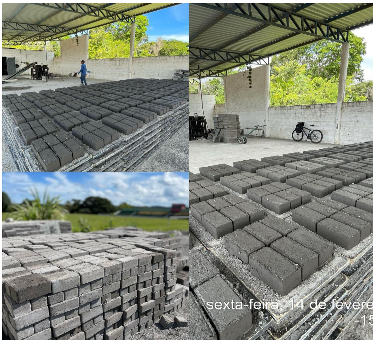
Fabricação de Blocos intertravados
