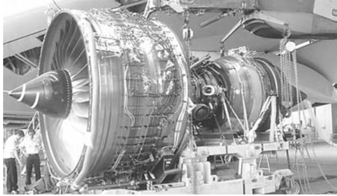
Στη φωτογραφία που δόθηκε χθες στη δημοσιότητα, Αυστραλοί τεχνικοί απουσύνδουν τον χαλασμένο κινητήρα της «Rolls-Royce» από το αεροσκάφος της «Qantas A380» που είχε κάνει αναγκαστική προσγείωση στη Σιγκαπούρη, στις 4 Νοεμβρίου, χάρη στη δεξιοτεχνία των πιλότων.
