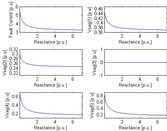
Fig. 4.  $I_f(x)$  and  $V_{sag}(x)$ .
