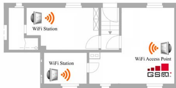
Bild 6 Kopplung von InstaMon-Geräten über WiFi
