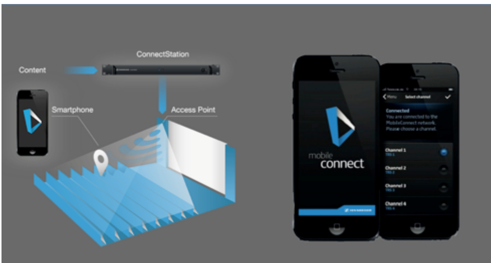
Abbildung 2: Schematische Darstellung der Streaming Technologie und der zugährigen Smartphone-App
