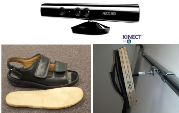
Bild 4 Hardware-Komponenten KINECT, Schuh und sensorbestückte Sohle, Handsensor „Wollie-Action“ an Schiene
