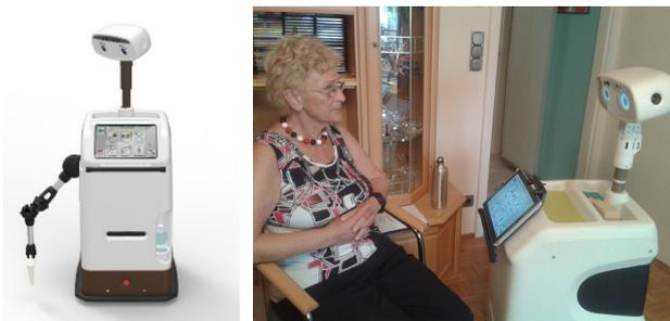
**Bild 3** Roboter im Projekt HOBBIT (links: Design des finalen Prototyps, rechtes: Interaktionsszene während eines der mehrwöchigen Feldtests in privaten Wohnungen)
