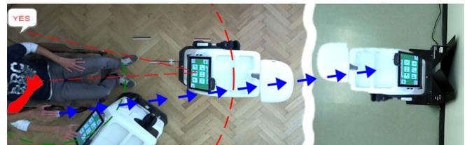
**Bild 5** Interaktionsdistanzen bei HOBBIT aus der Vogelperspektive: Nahbereich: Touch; mittlerer Bereich: Sprache, Gesten; Fernbereich: Ruftaster.
