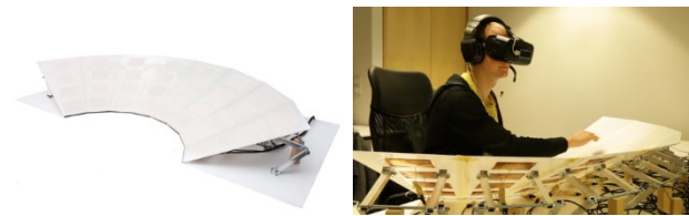
Bild 6 Links: Curved-Interaktionsgerät zur Freiform-Interaktion - Rechts: Unterstützung der Interaktion über die Annäherung der Oberfläche an die natürlichen Armbewegung in Virtual Reality Umgebungen.
