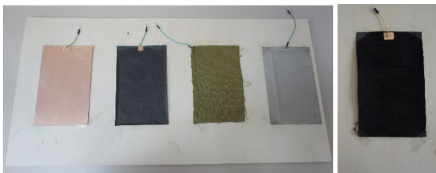
Bild 1 Beispiele verschiedener Elektrodenmaterialien für Selbstkapazitätsmessungen: (von links nach rechts) Kupferelektrode, leitende Farbe, leitender Faden, leitender Stoff und leitende Farbe auf Stoff [9]
