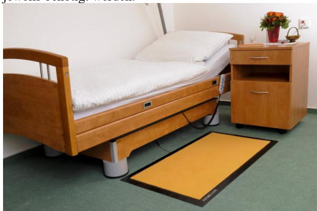
Bild 6 SensFloor Matten zur Meldung von nächtlicher Aktivität sturzgefährdeter Bewohner.
