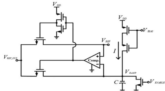
Fig. 2 Soft-Starting Circuit
