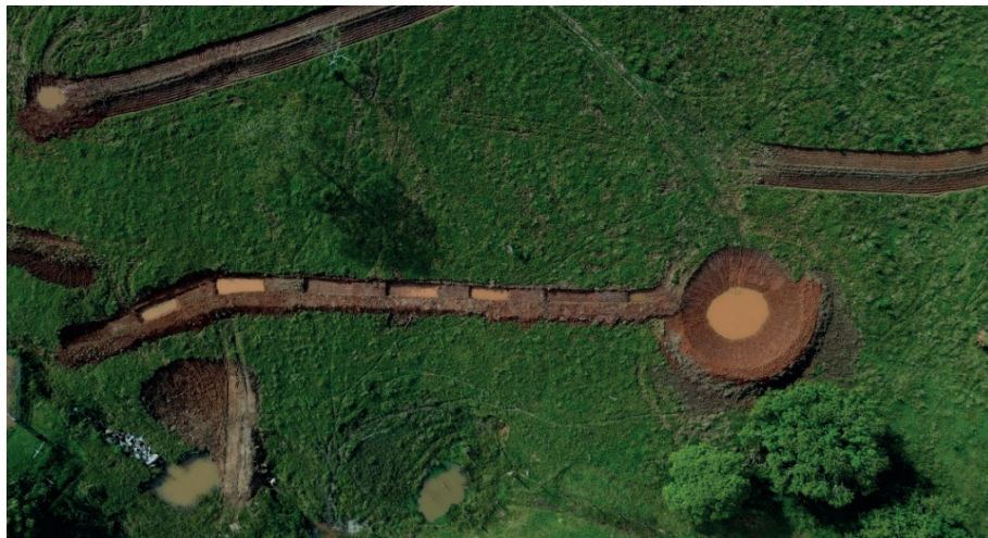
Figura 3 - No centro da imagem, cochinho integrado à barraginha na Chácara São José, estrutura destinada à condução e dissipação do escoamento superficial, favorecendo a infiltração de água no solo e a conservação hídrica da paisagem.
