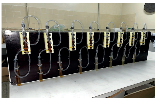
Figura 2 - Configuração experimental utilizada para ensaios de fermentação alcoólica.
