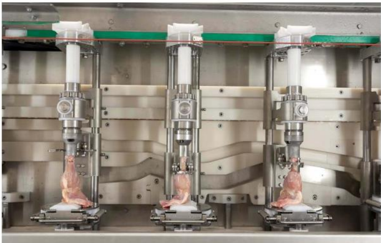
Figura 9.2.3.5.a Deshuesadora de carne de muslito de aves de corral que funciona cortando y empujando la carne. Cortesía de Meyn.
