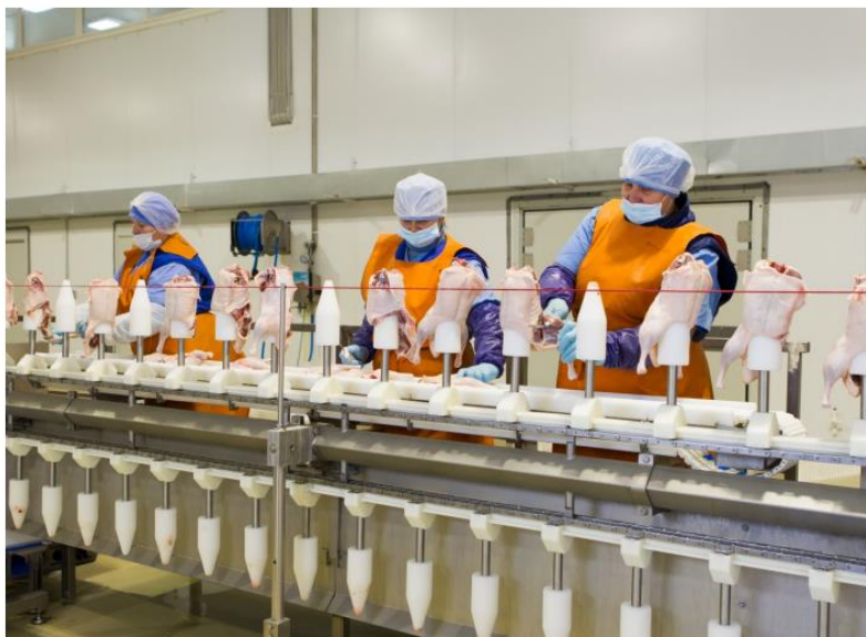
Figura 9.2.2.1 El sistema de cono utilizado para el deshuesado manual de la carne de aves de corral
