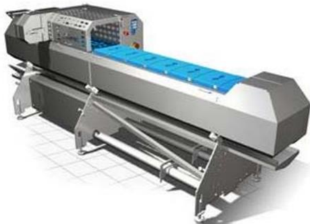
Figura 9.3.3 Máquina para el corte de porciones predeterminadas utilizando un molde fijo. Cortesía de Stork.
