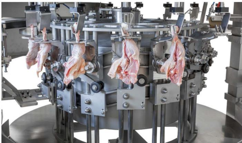
Figure 9.2.3.5.b Una deshuesadora automatizada de muslo entero. Cortesía de Foodmate.
