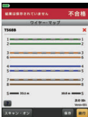
グラフィカルなワイヤーマップ表示 (シールドの断線箇所も検出可能)
