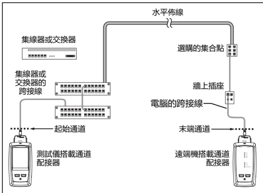
圖 4. 通道連接，適用的連結最高 Cat 7<sub>A</sub>
