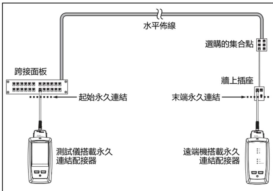
圖 3. 永久連結連接，適用的連結最高 Cat 7<sub>A</sub>
