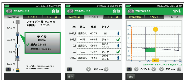
図 5. OTDR 結果画面の例
