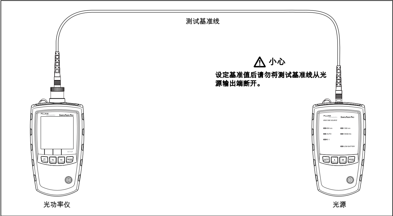
图 10. 基准连接 ( 1 个跳接法 )
