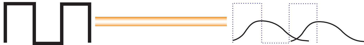
Figura 9: El efecto resultante de la dispersión hace que los pulsos transmitidos lleguen a la vez y se solapen en el extremo del enlace (entrada al detector). El detector ya no es capaz de reconocer ni descodificar el estado de cada uno de los pulsos.
