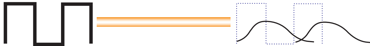
Abbildung 9: Der Nettoeffekt der Dispersion führt dazu, dass sich die übertragenen Impulse überlagern und am Ende der Glasfaser-Verkabelung überlappen (Eingang zum Detektor). Der Detektor kann den Zustand einzelner Impulse nicht mehr erkennen und decodieren.
