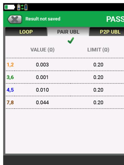
Um desbalanceamento muito grande causa a saturação do transformador do equipamento de fonte de alimentação. Isso resulta em distorção dos dados, causando erros de bits, retransmissões e até mesmo links de dados não funcionais.
