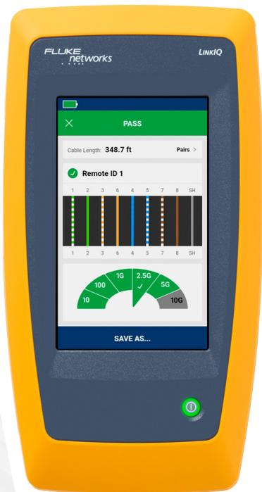
O "velocímetro" do LinkIQ™ indica a taxa máxima de dados de Ethernet suportada pelo cabeamento.
