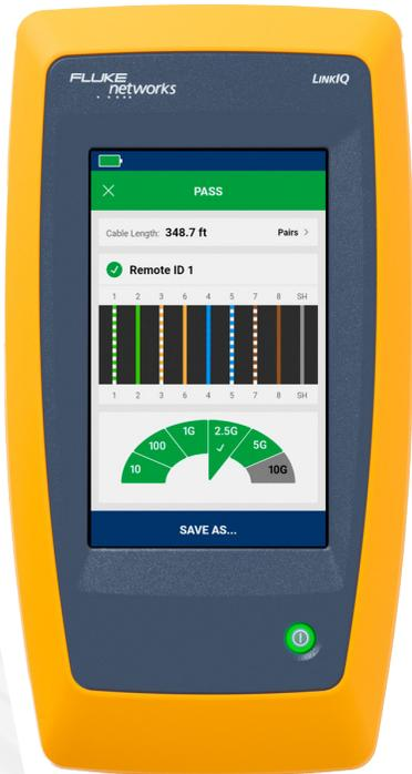
Das LinkIQ™ "Speedometer" gibt die maximale Ethernet-Datenrate an, die von der Verkabelung unterstützt wird.
