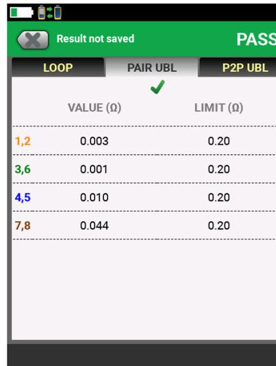
Eine zu große Unsymmetrie führt zur Sättigung des PSE-Transformators. Dies führt zu Verzerrung der Datensignale, die Bitfehler, erneute Übertragungen und sogar nicht funktionierende Datenverbindungen verursachen.
