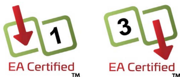
Abbildung 3. Ethernet Alliance-Markierungen für versorgte Geräte (links) und Geräte für die Spannungsversorgung (rechts).
