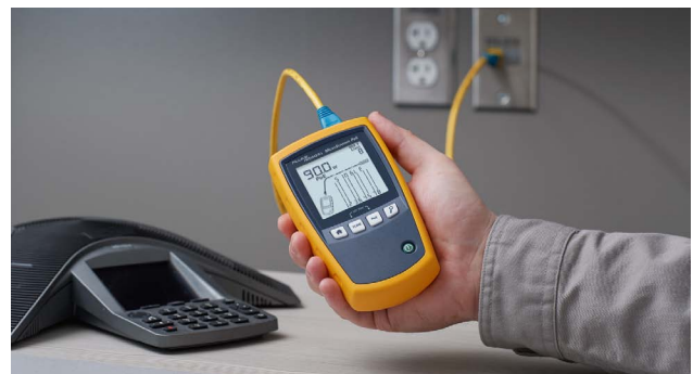
Abbildung 5. Der MicroScanner PoE kann die vom PSE gelieferte Versorgung sowie die Netzwerkgeschwindigkeit feststellen und enthält auch eine Reihe von Kabelprüffunktionen.
