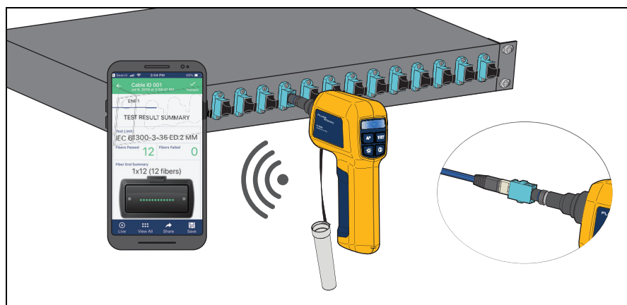
Figura 8. Inspección de un extremo (se muestra la sonda MPO)
