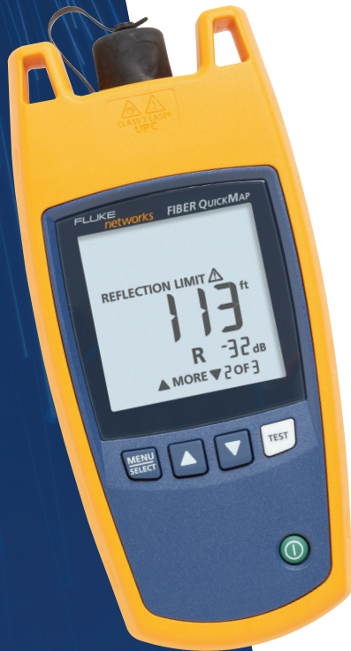
그림 9. Fiber QuickMap 결함 로케이터는 결함까지의 거리를 표시합니다.
