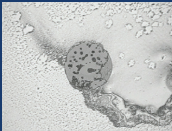
그림 6. 알코올을 사용한 청소 후 남은 잔여물. 적절한 용제를 사용하는 습식 청소가 필요한 종단면의 좋은 예.
