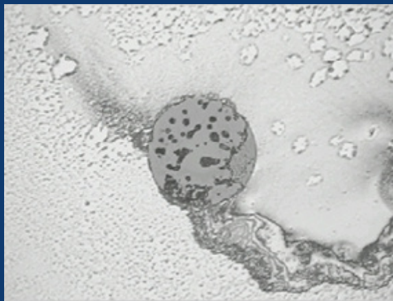
图 6。 使用酒精清洁后留下的残留物。需要使用适当溶剂进行湿式清洁的端面（典型示例）。
