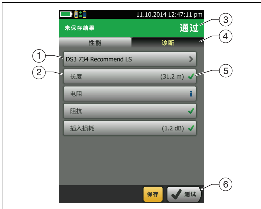
图 25. 同轴电缆的自动测试结果
