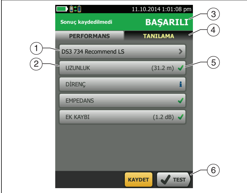
Şekil 25. Koaksiyel Kablolama için Otomatik Test Sonuçları
