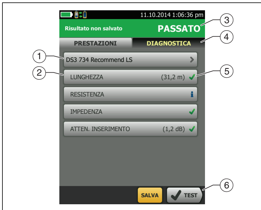
Figura 25. Risultati del test automatico dei cavi coassiali
