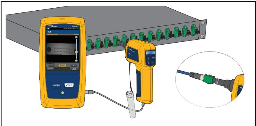
**Figure 48. Inspection d'une extrémité (ici avec la sonde FI-3000)**
