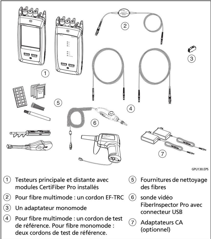
**Figure 66. Equipement d'auto-test en mode source distante**
