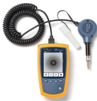
Figure 2b: Fluke Networks FI-500 FiberInspector™ Micro écran et sonde.
