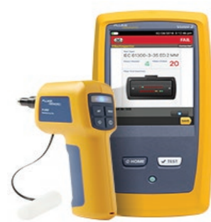
Figura 2c: FI-7300 de Fluke Networks La cámara de inspección de MPO y fibras individuales FiberInspector Pro proporciona resultados automatizados PASA/FALLA y utiliza Versiv para la visualización, como interfaz de usuario y para guardar los resultados.
