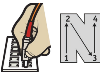
Figura 8: Metodología de limpieza “de húmedo a seco” usando una tarjeta de limpieza óptica de Fluke Networks. La gota de disolvente se pone en “1”, y el extremo se desliza por el material de limpieza desde el “1” hasta el “4”
