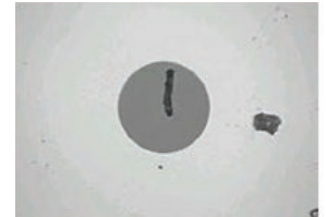
Figura 1: Las terminaciones de fibra sucias como la que se muestra aquí pueden degradar el rendimiento de la red o dañar los equipos
