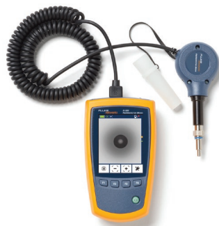
Figura 2b: Sonda y pantalla del FiberInspector™ Micro FI-500 de Fluke Networks.
