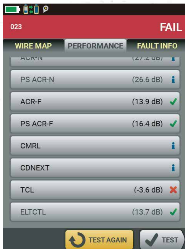
DSX CableAnalyzer显示不合格的E3等级测试结果。请注意是TCL不合格。
