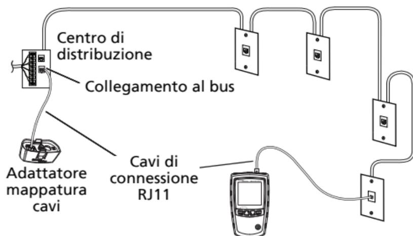
Nota: è possibile scambiare le posizioni del tester e dell'adattatore mappatura cavi.
