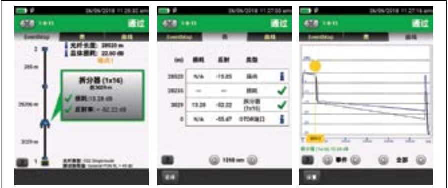
图 4. 无源光网络 OTDR 结果屏幕示例
